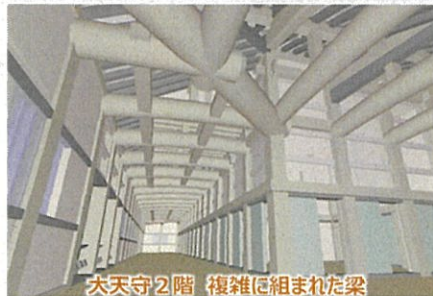
大天守2階 複雑に組まれた梁
